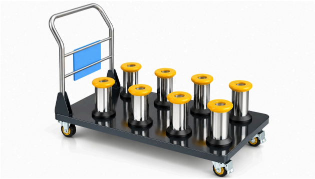
图 9 SleevePort 套筒移动库。图示为双排 8 工位结构，配置金属支撑柱、黄色防护圈、推行扶手及脚轮，用于套筒的立式存储与工位间转运。实际适配套筒内径、长度及承载要求应在选型时确认。
